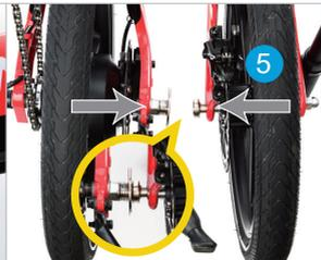
確定磁吸水平對齊吸附，輕放於平面，完成折疊。
